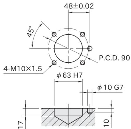
■ 夹具用安装孔尺寸图(柄)
