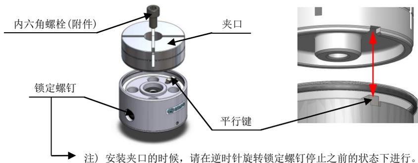
(2) 确认夹口是否在正确的位置并用内六角螺栓拧紧固定。
