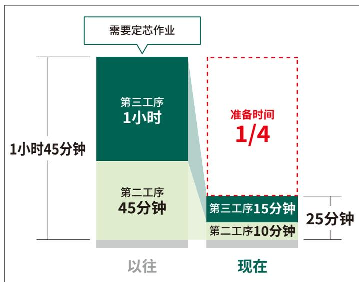
第一工序过去和现在都是用限位块定位，用压板夹紧。在以往的二、三工序中，通过使用螺栓在工件侧面的四个位置侧推工件，完成工件基准面的定芯作业。之后用压板轻轻夹紧工件，再对螺栓的突出量进行微调，最后拧紧夹具。这需要大量时间进行调节与设置。
