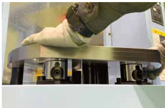
交换板的交换作业
