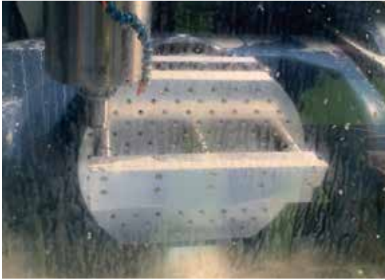
使用了圆柱型下拉式夹具的一次夹紧5面加工
